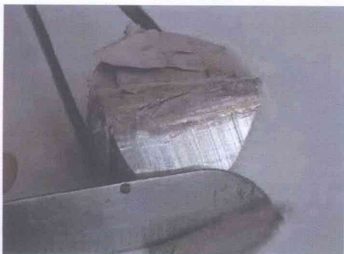
Figure 1 – Sodium solide découpé à l'air libre
