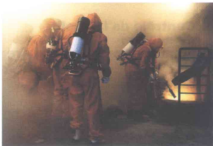
Figure 4 – Extinction d'un feu de sodium de plusieurs kilogrammes
